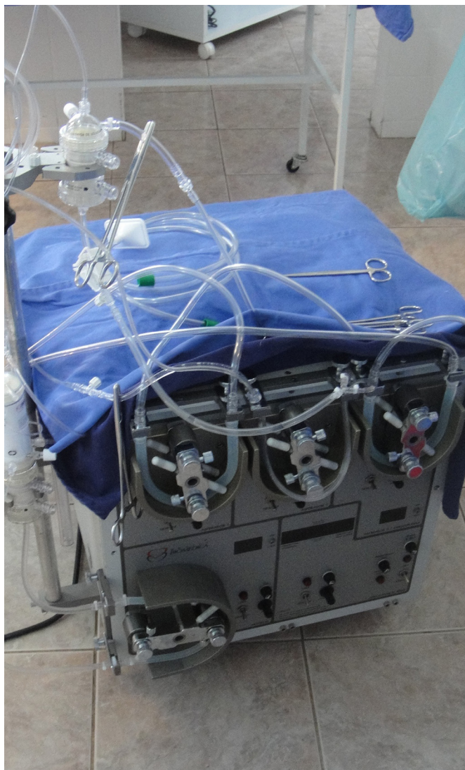
Figura 1 - Máquina de circulação extracorpórea, com oxigenador neonato humano.
